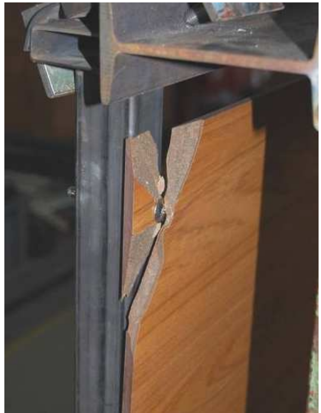
Zábradlí s výplní FUNDERMAX, dopadová energie 250 J, připevnění 4x šroub M6 na každé straně Obr. 3 Pohled na výplň typu 3 z čela
