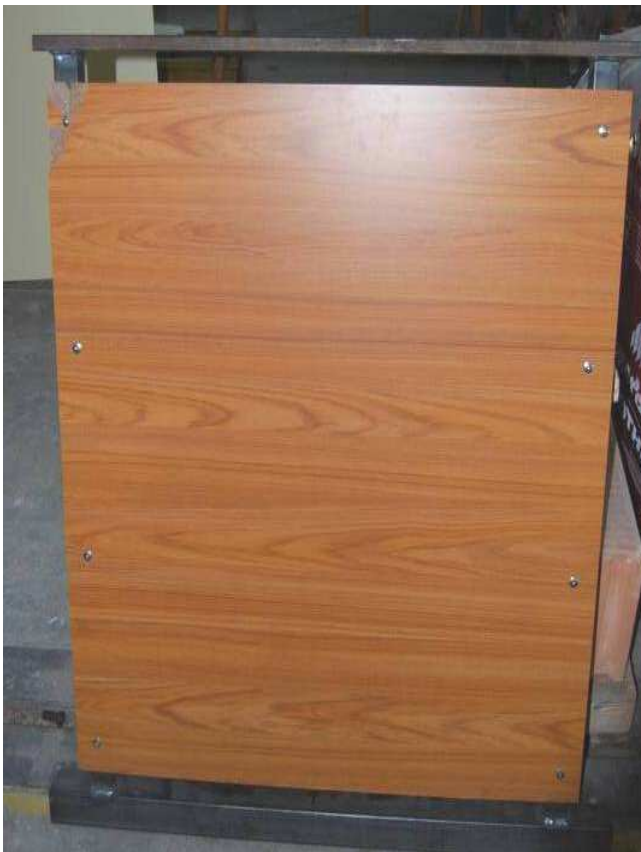
Zábradlí s výplní FUNDERMAX, dopadová energie 250 J, připevnění 4x šroub M6 na každé straně Obr. 3 Pohled na výplň typu 3 z čela
