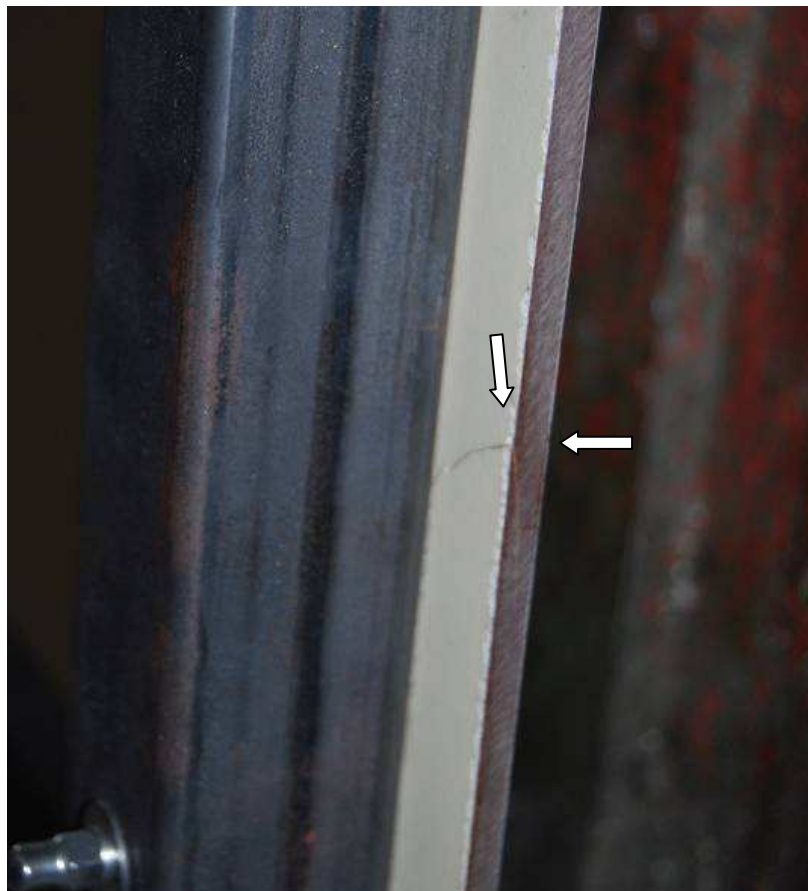
Obr. 2 Zábradlí s výplní FUNDERMAX, dopadová energie 150 J
